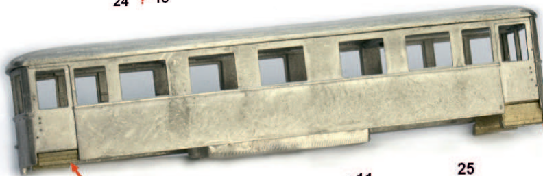
Einbau der Trittkästen 11 und Türschlussbleche 25
