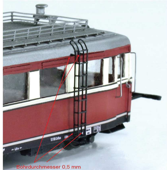
Die Leitern waren beidseitig direkt gegenüber liegend montiert
